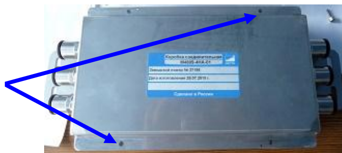
Рисунок 2 - Места пломбирования соединительной коробки весов M8101 для нанесения знака поверки
