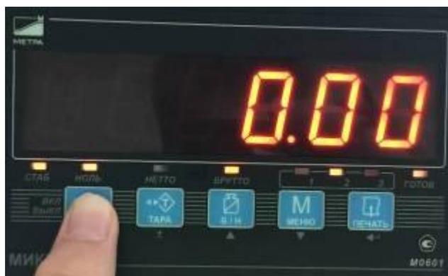
8. Затем установите на весы эталонную нагрузку (В нашем примере 5 тонн) и нажмите последовательно кнопки «МЕНЮ» и «ТАРА».
